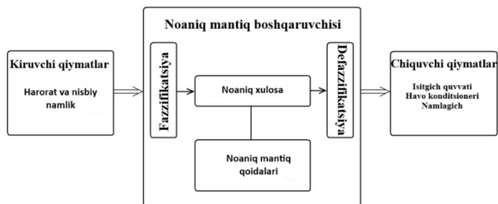
1-rasm. Noqatiymantiq boshqaruvchisiga asoslangan iqlim nazorati tizimining sxemasi.
