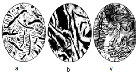
2-rasm.Quyma kulrang cho‘yanlarning mikrotuzilishlari: a - ferrit-grafitli; b - ferrit-perlitli; c - perlitli
