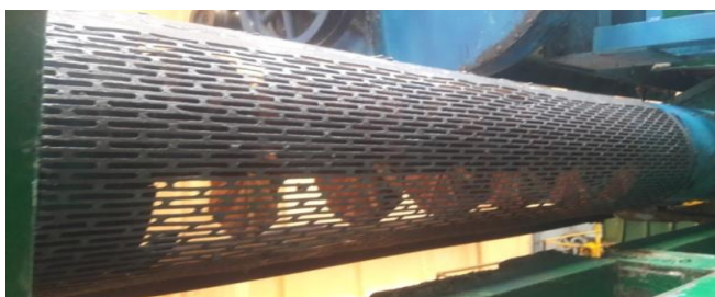
4-rasm. Iflosliklarni tashqariga chiqaruvchi setka.
