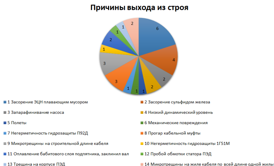
Рисунок 5. Диаграмма причин выхода из строя УЭЦН на нефтегазодобывающем управлении за 2022 год
