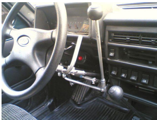
1-rasm. Boshqaruv elementlariga qattiq ulagichlar yordamida o'zgartirish kiritilgan avtomobil.
