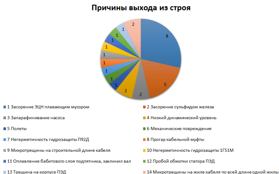
Рисунок 3. Диаграмма причин выхода из строя УЭЦН на нефтегазодобывающем управлении за 2020 год
