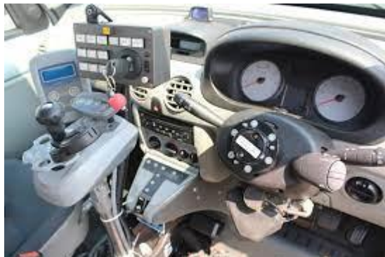
3-rasm. Yordamchi qurilmalar yordamida boshqaruv elementlari o'zgartirilgan avtomobil.
