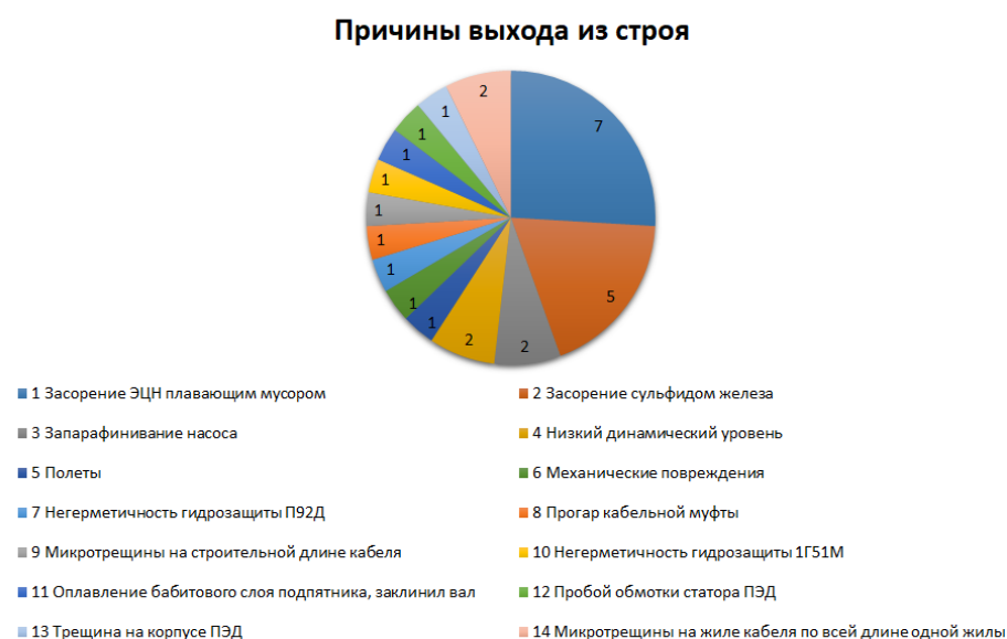
Рисунок 4. Диаграмма причин выхода из строя УЭЦН на нефтегазодобывающем управлении за 2021 год
