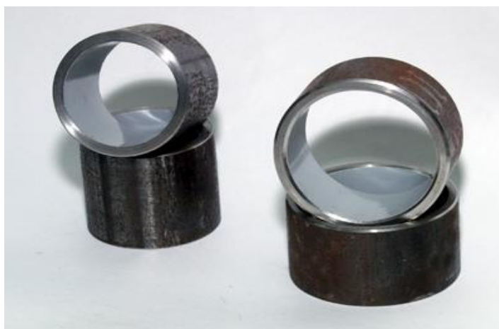
Рисунок 3 – Внутреннее состояние насосной трубы НКТ с ВЗП (внутренним защитным опылением)
