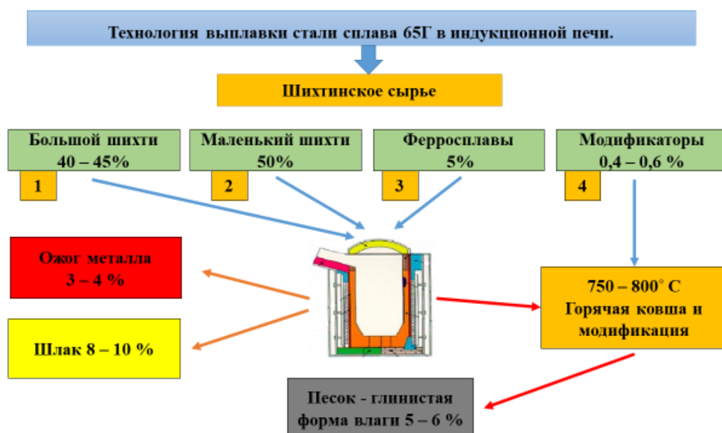
Форма 1: Технологическая схема выплавки высокоуглеродистой стали 65Г в индукционной печи
