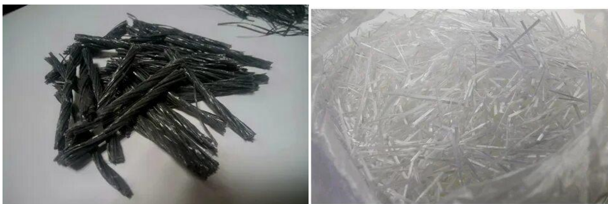
1.5-rasm. Polimer tolasini (Полимерная фибра).
