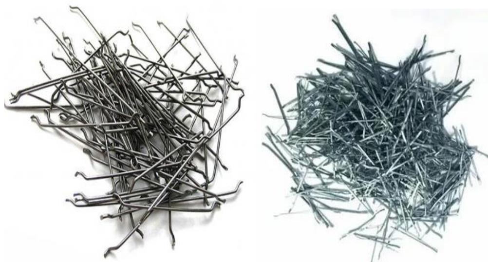
1.2-rasm. Metall tola (Фибра металлическая).
