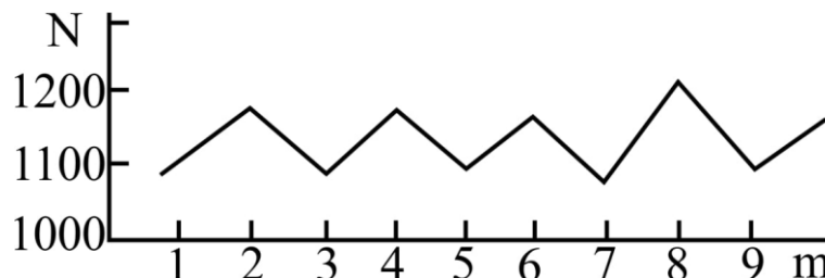
Рис. 2. Флуктуация показаний анализатора при измерении одной и той же среды: N — показания прибора; m — порядковый номер измерения.
