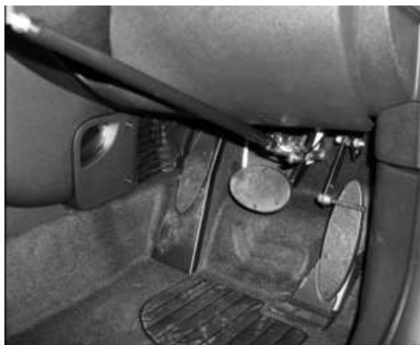
1-расм. Акселератор ва ишчи тормоз педалини ричакли бошқариш қурилмаси.
