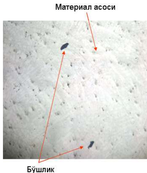
3–расм. 300а – белгили чўян намуна шлифининг травления килинмаган юзасидаги нуксонлар, х200
