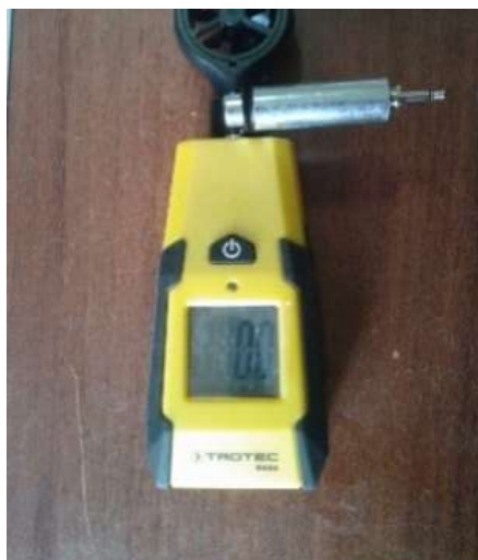
2-расм. Қуритиш агентининг тезлигини ўлчаш учун TROTEC ускунаси
