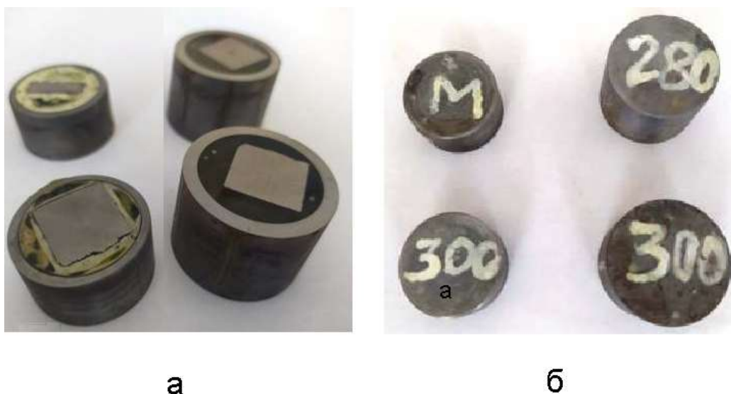
1–расм. Микроструктуравий тахлил учун тайёрланган чўян намуналарнинг шлифлари: а – шлиф юза томони; б – намуналар белгилари
