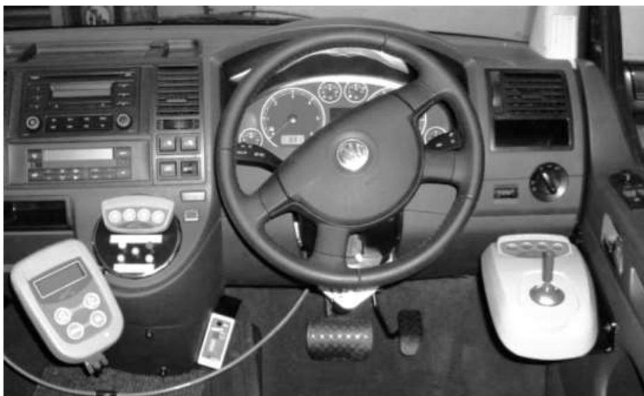
4-расм. Автомобил агрегатларини масофадан бошқариш тизими.
