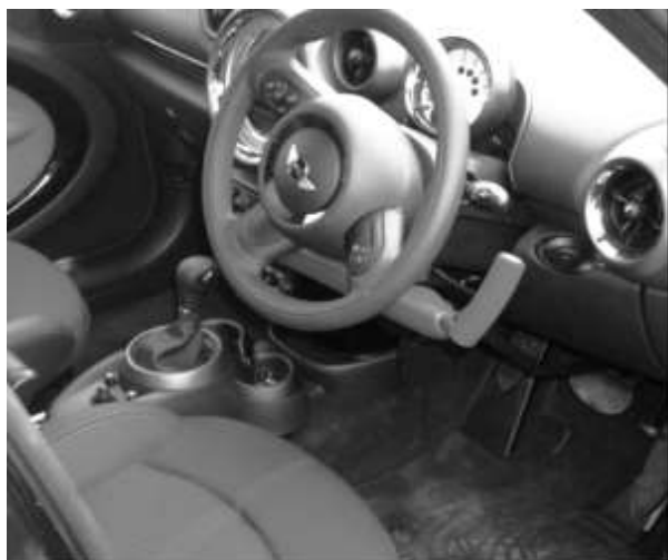
1-расм. Акселератор ва ишчи тормоз педалини ричакли бошқариш қурилмаси.
