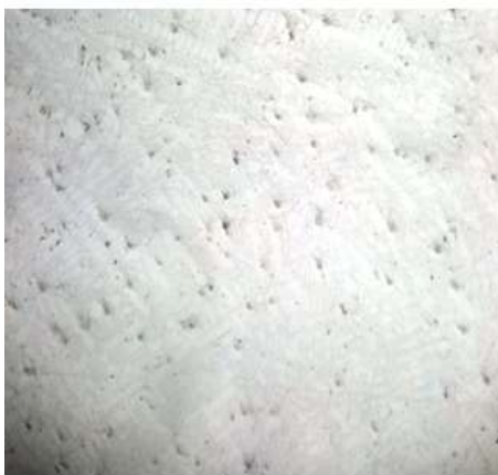
5 – расм. М – белгили чўян намуна шлифининг травления килинмаган юзасида, х200
