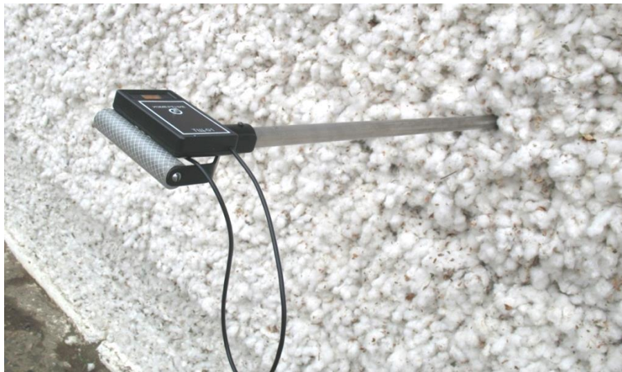
1-rasm. KT-1 elektron harorat o'lchagich yordamida g'aramdagi saqlanayotgan paxta xomashyosini haroratini o'lchash.
