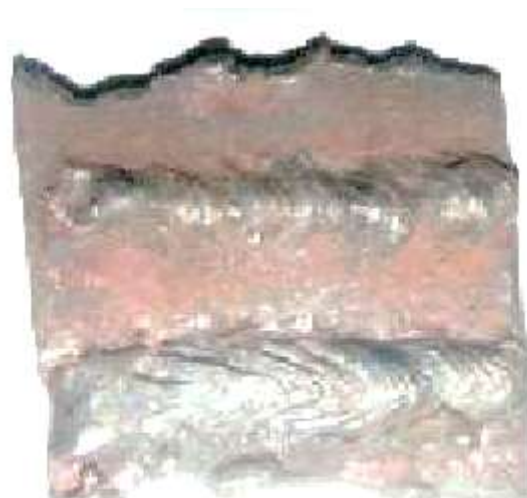
3-расм. Экспериментал намуна асосида таёрланган электрод билан пайвандланган металл чокининг кўриниши.
